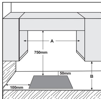
**ПРИМЕЧАНИЕ:** Если расстояние **A** между настенными шкафчиками составляет от 600 мм до 730 мм, то высота **B** должна быть не менее 530 мм. Если расстояние **“A”** между корпусами настенной мебели больше ширины варочной панели, то высота **“B”** должна быть не менее 400 мм. В случае установки над варочной панелью вытяжки необходимо соблюдать размеры, указанные в руководстве по эксплуатации вытяжки
