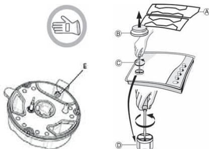
Прежде чем устанавливать варочную панель, не забудьте прикрепить прилагаемую к инжекторам табличку с данными, касающимися нового типа газа, таким образом, чтобы она закрыла собой табличку, относящуюся к предыдущему типу газа
