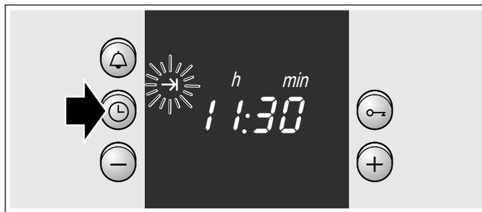
6. Вы можете установить более позднее время окончания с помощью кнопки +. Через несколько секунд установка автоматически принимается. Время окончания будет отображаться на дисплее, пока духовой шкаф не начнёт работать.
