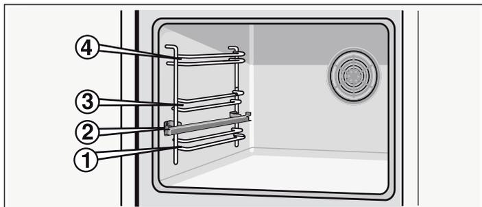
Если принадлежности выдвинуть примерно наполовину, то они фиксируются в этом положении. Благодаря этому готовые блюда можно легко вынуть.
