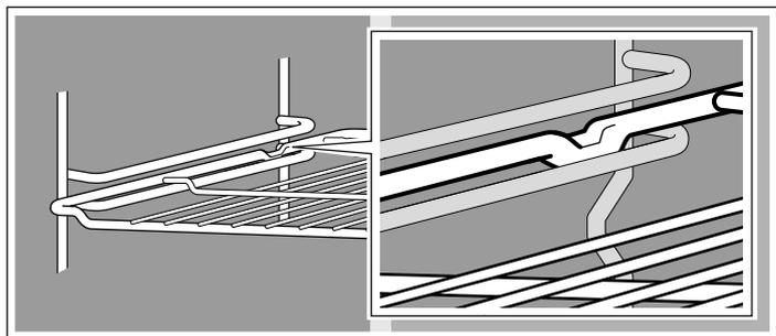
С помощью выдвижных направляющих на уровне 2 можно выдвигать принадлежности.
